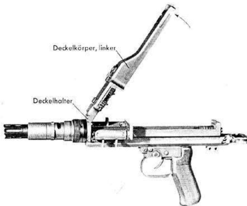
Abb. 35: MG 81; Öffnen des Deckels
