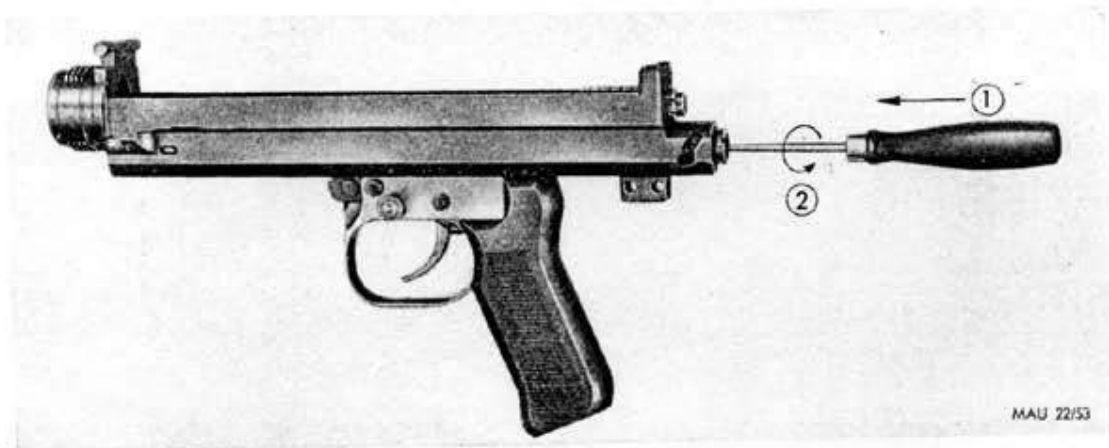
Abb. 53: MG 81; Lösen des Führungsrohres aus seinem Bajonettverschluß
