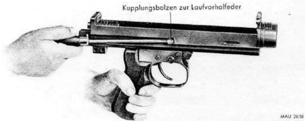
Abb. 58: MG 81; Ausrasten des Kupplungsbolzens
