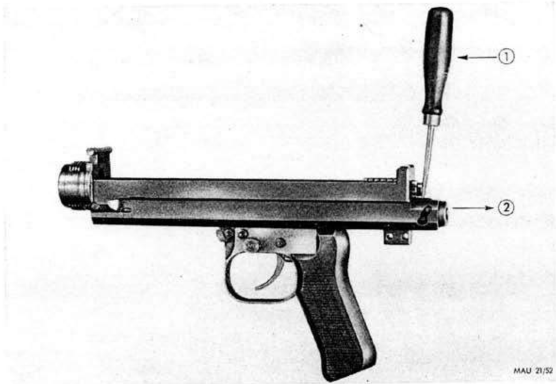
Abb. 52: MG 81; Abnehmen der Sicherungsscheibe
