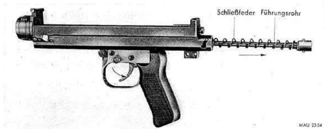
Abb. 54: MG 81; Herausnehmen des Führungsrohres und der Schließfeder
