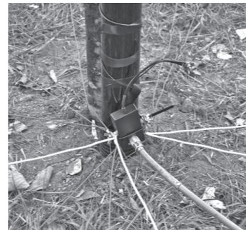
1.8MHz用パッチカル・アンテナの給電部(A50BOC、A5B) 10本以上のラジアルが見える
